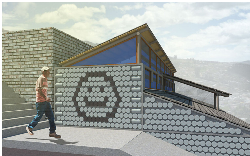
FIGURA 3 – Materialidade composta com corpos de prova de concreto no projeto Fábrica Cultural Atacucho.
