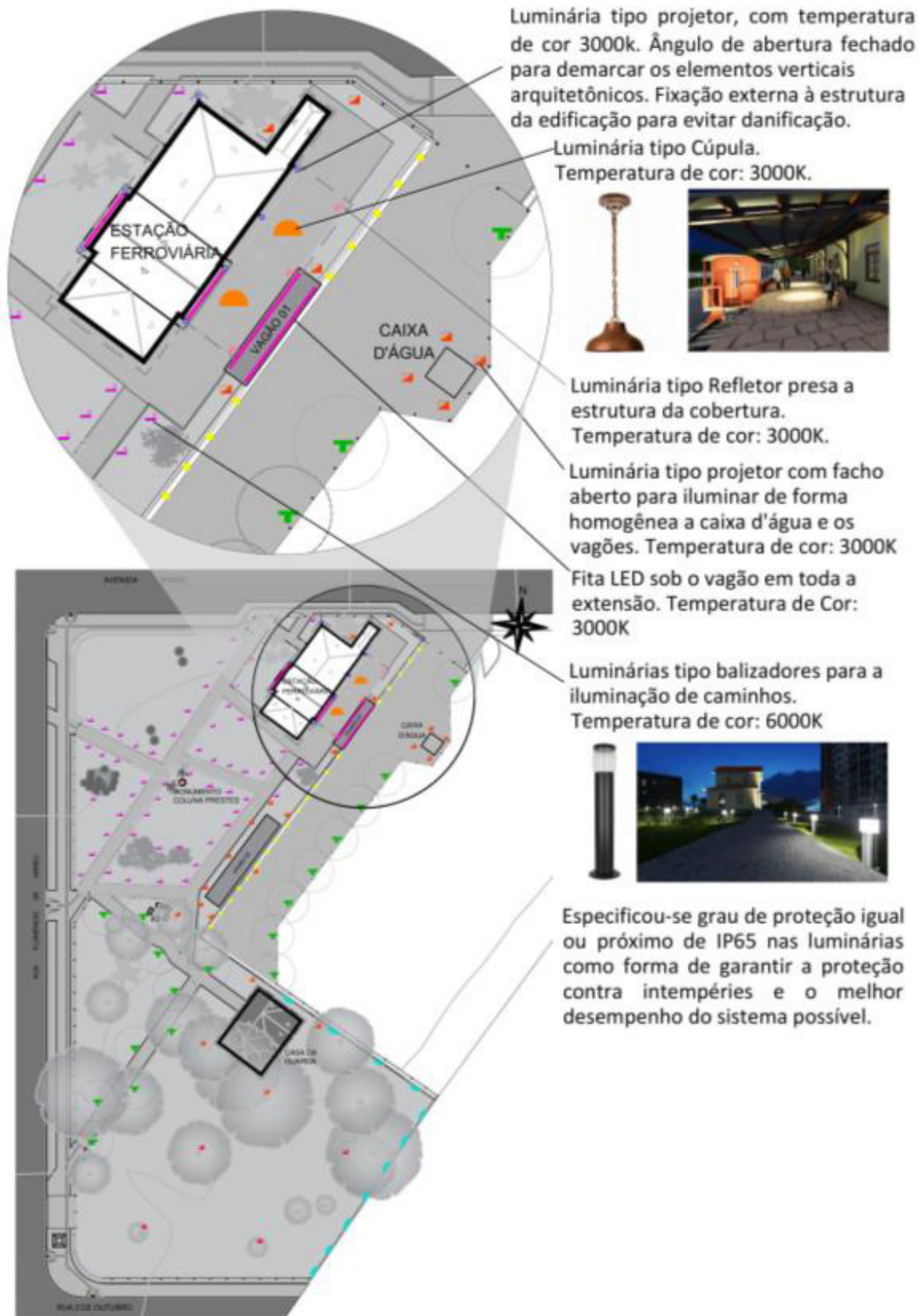
FIGURA 21 – Zoom da planta baixa dos pontos de iluminação com especificações.
