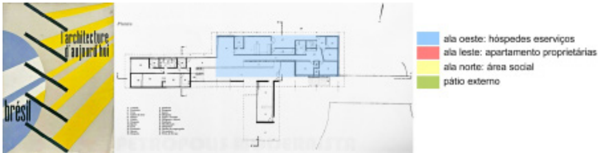
FIGURA 8 Capa e planta baixa publicada na Revista L'Architecture D'aujourd'hui de 1952, onde é possível perceber diferentes configurações de layout arquitetônico dos trechos ainda não edificados correspondentes a 'ala leste' e 'ala norte', assim como limites do pátio frontal em trecho sinuoso. Outra curiosidade é perceber o deslocamento dos pilares ao fundo da ala oeste (parte superior do desenho) tornando a estrutura aparente também no pátio de serviços – o que também não foi executado desta maneira.
