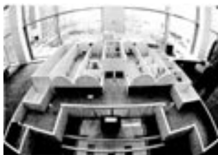
Fig.1. Foto de um modelo físico em escala reduzida confeccionado com o propósito de representar, o mais próximo possível, as características da iluminação natural do ambiente
