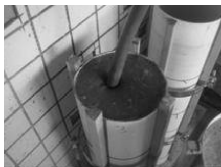
FIGURA 11 - Vibração da argamassa do corpo de prova
