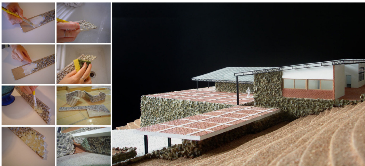
FIGURA 2 - A esquerda, fotos do processo de experimentação e confecção das paredes de pedra; e a direita, sua aplicação final na fachada noroeste do modelo reduzido na escala 1:50.
