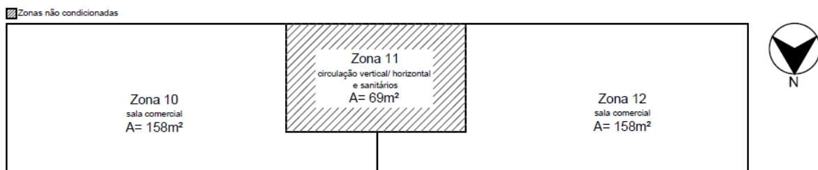
FIGURA 4 - Zoneamento térmico dos pavimentos superiores
